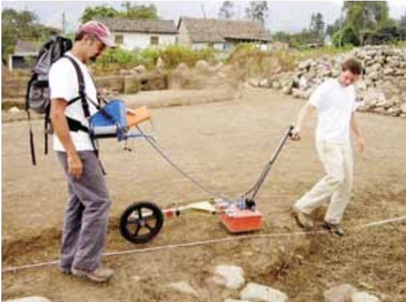
Arqueología de campo (aplicación de GPR-sensores remotos)
