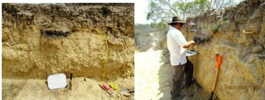
Foto 196. Nivelado de la piola de control      Foto 197. Toma de muestras de suelo
