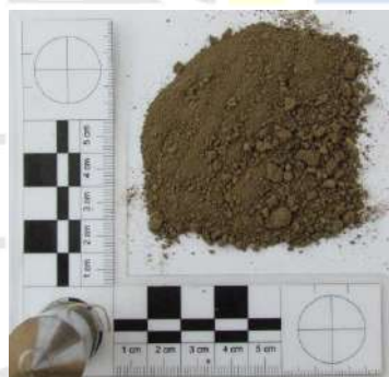
Foto 48: suelo del terraplén o Estructura C2
